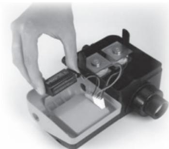
1. Appuyez sur les deux boutons situés de part et d'autre du panneau avant puis introduisez une pile alcaline 9V neuve en respectant la polarité.
