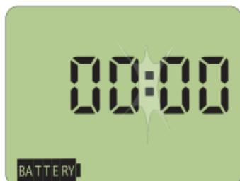
Pour rétablir complètement les paramètres d'usine par défaut, appuyez sur les touches ◀ et ▶ pendant environ 5 secondes jusqu'à ce que 00:00 apparaisse sur l'afficheur.
